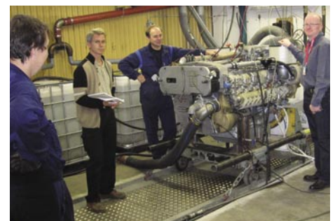
Klart för provkörning i motorbänken.
